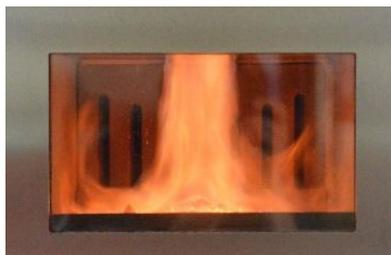
**N.B.:** Con valvola leggermente aperta, il tiraggio sale ed i vetri rimangono puliti. Se la temperatura dei fumi supera 150°C chiudere la valvola completamente.
