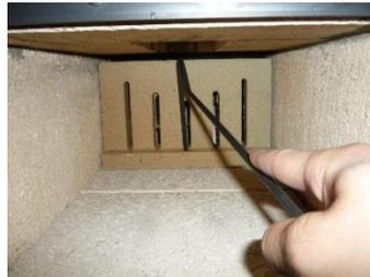
Spazzola in acciaio inox (camera di comb. inferiore)
