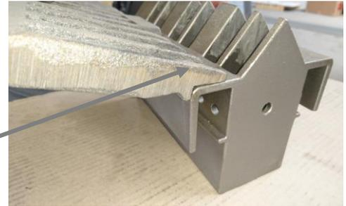
**Importante:** Le griglie devono appoggiare al blocco iniettore come visibile sulla foto per garantire un buon funzionamento della fiamma inversa. Se sono consumati prevedere la sostituzione.
