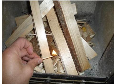
**L´obiettivo é** di riscaldare bene la termostufa (refrattari della camera di combustione superiore, il contenuto d´acqua dello scambiatore) e la canna fumaria per l´aumento del tiraggio fumi e di produrre 3- 4 cm di brace.
