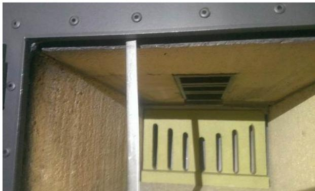
La pulizia del deviatore della fiamma favorisce un buon funzionamento della fiamma inversa.
