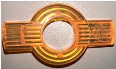
*Il magnete di rilascio servoazionamento*
