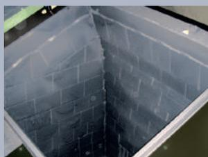
Opzionalmente la HDG Euro è disponibile con un rivestimento refrattario speciale saldato nella camera di carico per una combustione lunga di cippato, bricchetti pressati e scarti di falegnameria secondo le classi di combustione 6 e 7 (ai sensi della prima BImSchV, Legge federale sul controllo delle emissioni,
